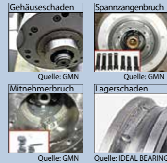
Kollisionskosten und Schäden
