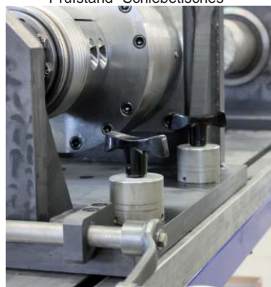
Kraftspannmutter MCA-T zur Arretierung eines Prüfstand- Schiebetrages
