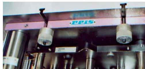
Kraftspannmutter MCA zum Klemmen eines Unter- und Oberwerkzeuges in einer Hydraulikpresse
