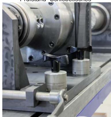
Kraftspannmutter MCA-T zur Arretierung eines Prüfstand- Schiebetrages
