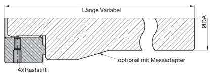
Der Innendurchmesser der Ringkraftaufnehmer ist mittels vier Kugelraststiften für die Aufnahme von Messadapterstücken vorbereitet. Kundenspezifische Adapterausführungen auf Anfrage.
