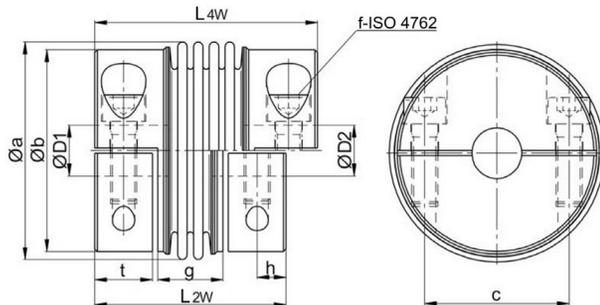
**Hinweis:** Standardausführungen mit 6-welligen Metallbalg 6W, 4-welligem Metallbalg 4W oder mit 2-welligem Metallbalg 2W -> siehe Klammerwerte. Verbindung von Balg und Naben durch Micro-Plasma-Schweißverfahren.
