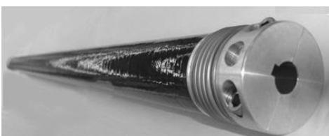
**Hinweis:** Das Zwischenrohr kann in unterschiedlicher Werkstoffausführung sowie in gerichteter und gewuchteter Qualität geliefert werden. Bei hohen Betriebsdrehzahlen über 2000 min<sup>-1</sup> und gleichzeitig großen Baulängen  $L > 2$  m sollte aufgrund der zulässigen biegekritischen Drehzahlen eine Überprüfung durch unsere Techniker erfolgen.
