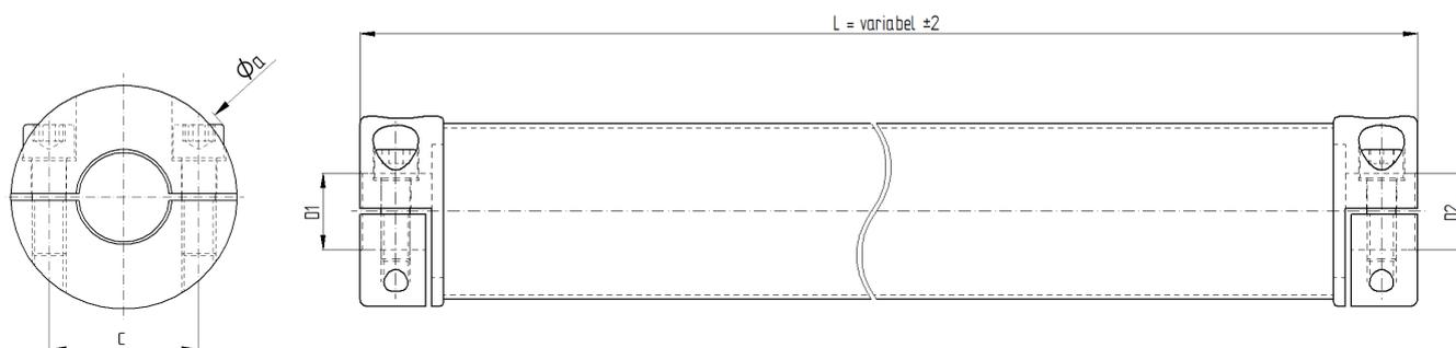
Werkstoffausführung: Nabe: hochfestes Aluminium Zwischenrohr: CFK
